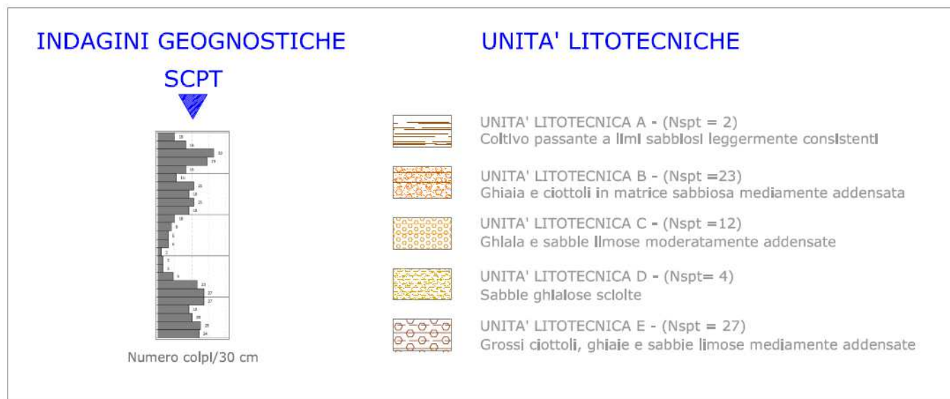
Figura 18 – Sezione stratigrafica interpretativa del sottosuolo
